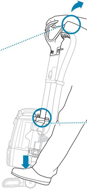
Appuyez sur la buse de plancher et inclinez la poignée pour activer la brosse rotative.
